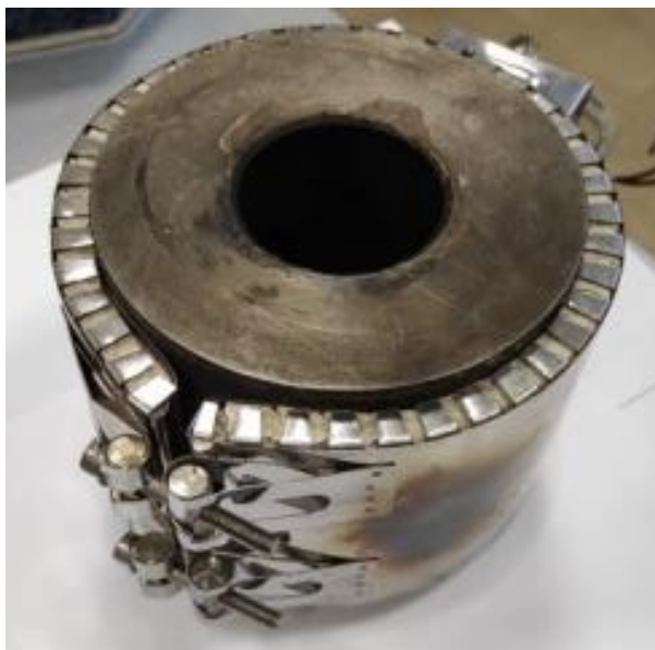
Рисунок 2.1. Пресс-форма с внешним нагревателем.
