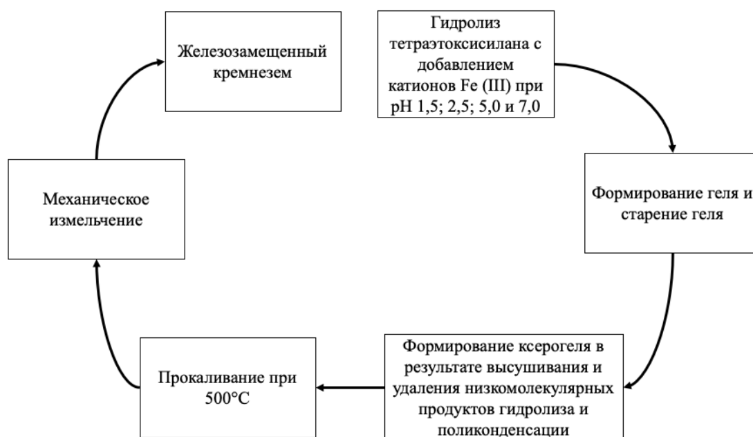
Рис. 2.2 Стадии получения кремнеземов, легированных катионами \text{Fe}^{3+}
