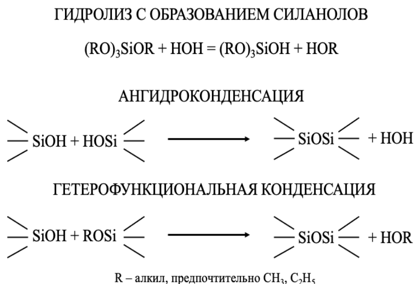
Рис. 1.1 Схема химических процессов, протекающих при золь-гель синтезе материалов из алкоксисоединения кремния
